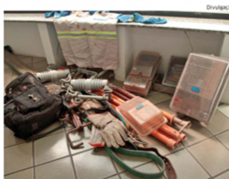
Equipamentos utilizados para fazer a fraude em medidores de energia
