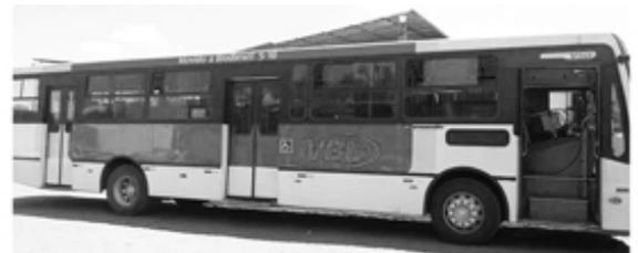
Novo ônibus da empresa Viação Branca de Leste é movido a óleo biodiesel, o que reduz em 60% as emissões de óxido de nitrogênio
